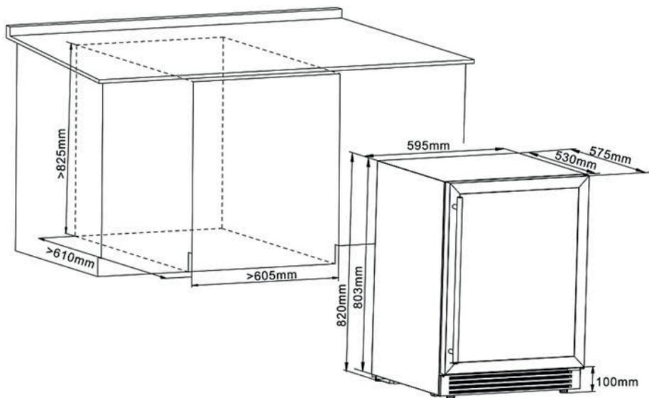
Para instalação próxima a uma parede, deixe um mínimo de (200 mm) do lado da parede para abrir a porta e movimentar as gavetas internas. Recomenda-se não instalar os aparelhos perto de uma fonte de calor, como um forno ou fogão.
