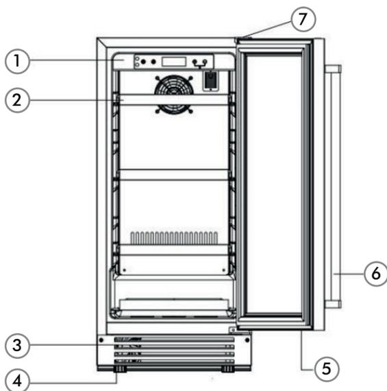
1. Painel de controle de temperatura e iluminação
