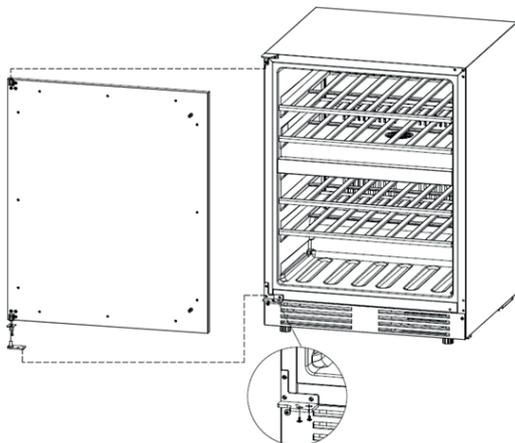
Etapa 4. Instale o batente da porta e a dobradiça inferior seguindo a figura 3 e fixe-os com parafusos.
