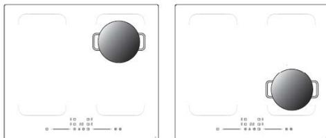
(b) Coloque duas panelas em ambos os lados da zona flexível.
